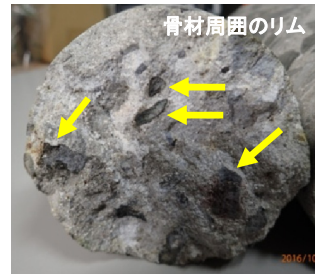
(b)破断面の状況
