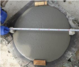
写真-1 スランプフロー試験状況
