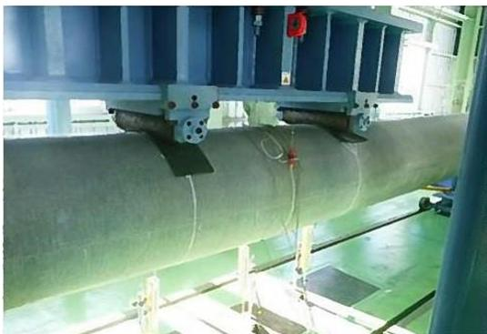
写真-2 曲げ試験状況
