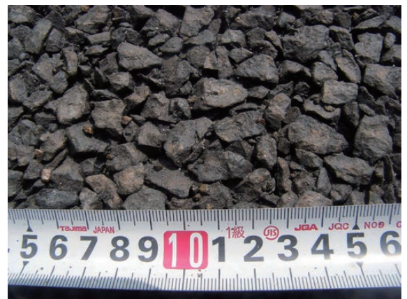
写真-4 供試体の路面 (すり磨き: 新規=0:100)
