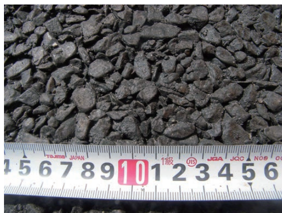
写真-2 供試体の路面(すり磨き:新規=100:0)
