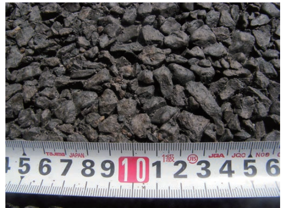
写真-3 供試体の路面 (すり磨き: 新規=50:50)
