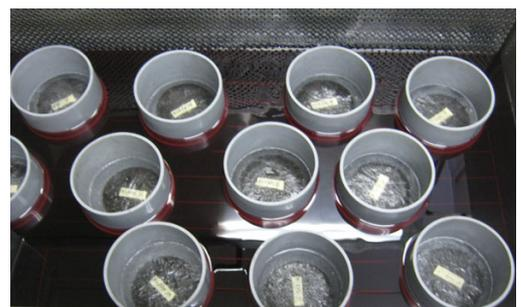
図-2 円柱状供試体の凍結融解状況
