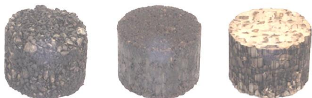
写真-1 油浸後供試体 (左: 通常 中: 高耐久 右: 半たわみ)
