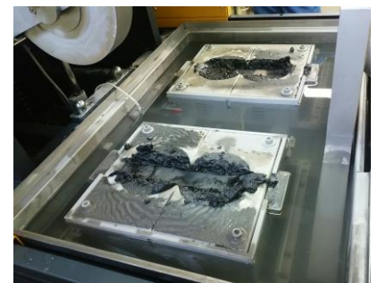
写真-2 HWT 試験後の状況
