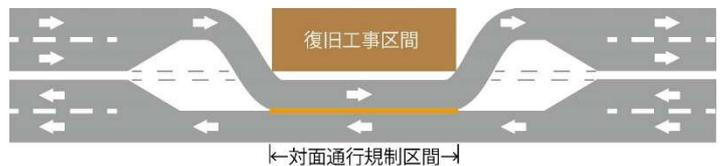
図1 片側1車線の対面通行規制イメージ
