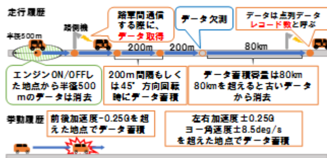
図-1 ETC2.0 プローブ情報の収集イメージ
