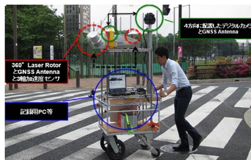
図-1 歩道計測型MMSの概要
