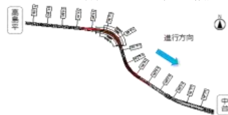
図-3 注意喚起カラー舗装（西台Sカーブ）
