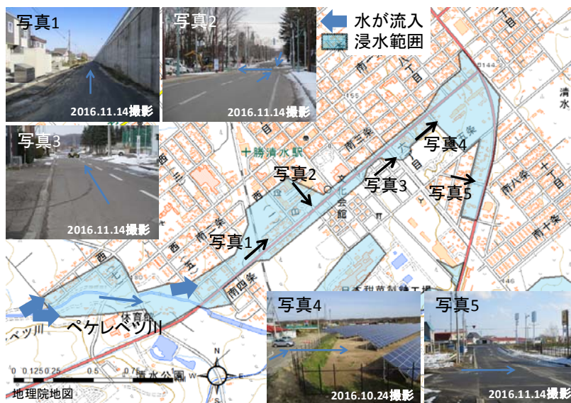
図-4 清水市街地の浸水範囲と水が流入した主な地点 水の流れに影響した主な地形及び施設
