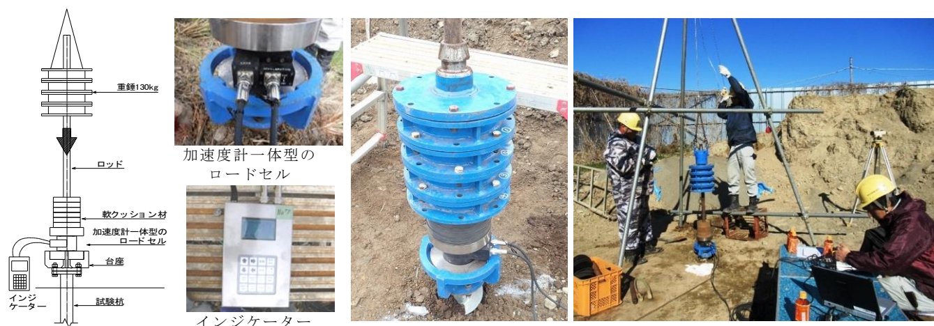
写真 2 簡易な急速載荷試験概要
