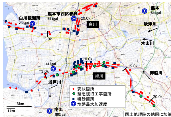
図-1 白川・緑川の河川堤防被害概要 1)
