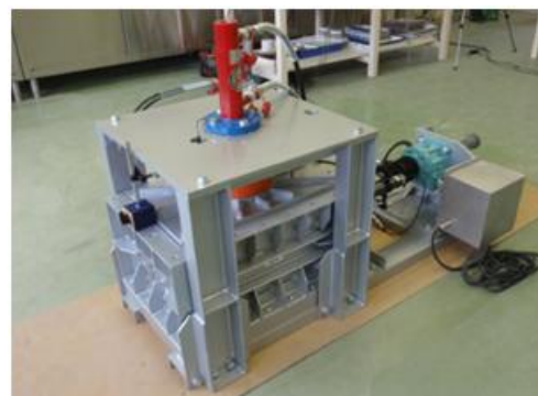
写真-1 引抜試験機
