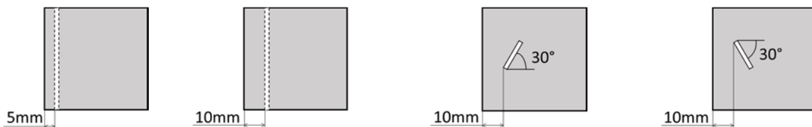
(a) 空隙深さ 5mm (b) 空隙深さ 10mm (c) 空隙深さ 10mm, 角度 30° (d) 空隙深さ 10mm, 角度 330°
