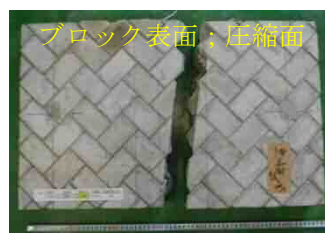
写真-8 Case2 の破壊形態
