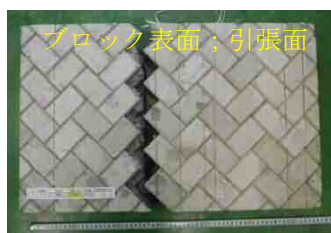
写真-7 Case1 の破壊形態
