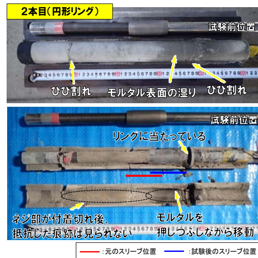
図-7 試験後の供試体状況
