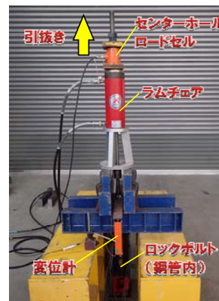
図-5 引抜き試験状況
