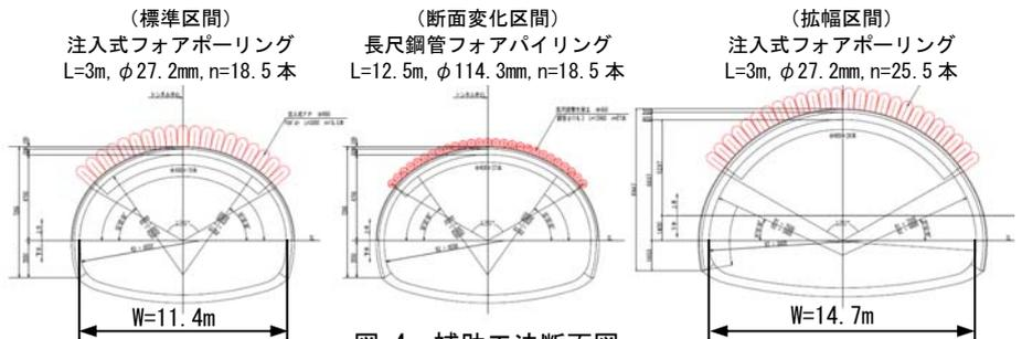
図-4 補助工法断面図
