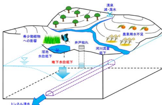
図-1 地下水位低下のリスクの概念
