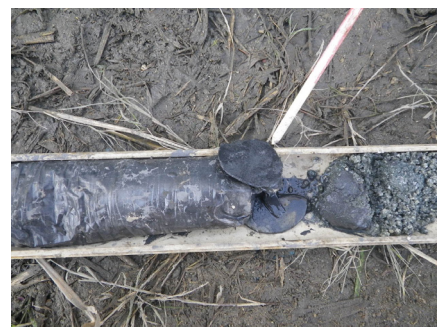
図-3 確認された遮水シート
