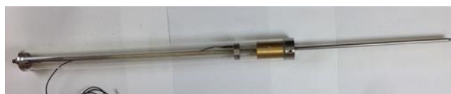
写真 1 小型動的簡易貫入試験機
