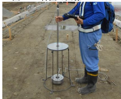
写真-1 落球探査法
