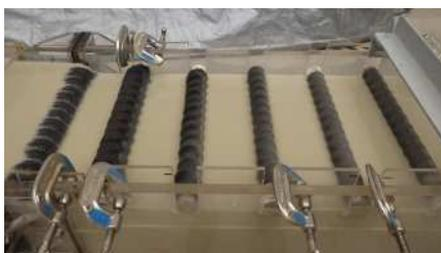
写真-2 鉄粉回収状況(棒磁石)
