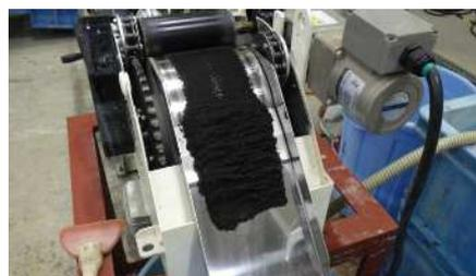
写真-3 鉄粉回収状況
