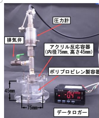
図 3 炭酸塩含有量試験装置
