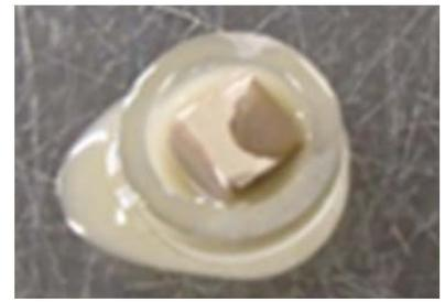
図-3 SEM 写真撮影用供試体の作成状況(硬化剤を塗布時)
