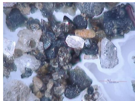
図1 噴砂の顕微鏡拡大写真 (熊本市南区)
