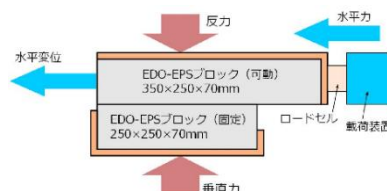
図-2 試験装置の概略
