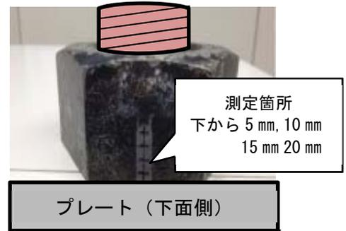
図-2 ナットの測定箇所拡大
