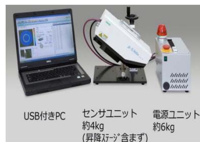
写真-2 X線残留応力装置
