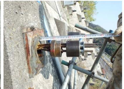
写真-8 引張り材の破断
