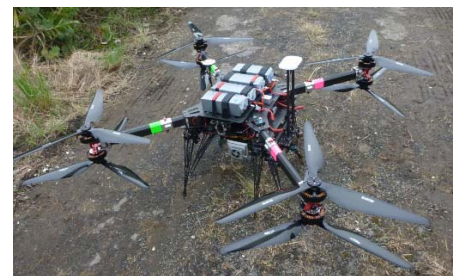
図 1 使用した GNSS+IMU+レーザスキャナ搭載型 UAV 機 (SPIDER-eX)
