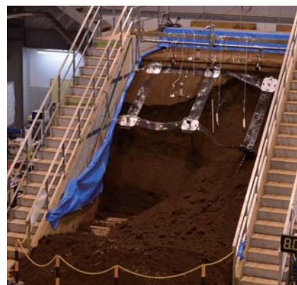
第6掘削後の崩壊
