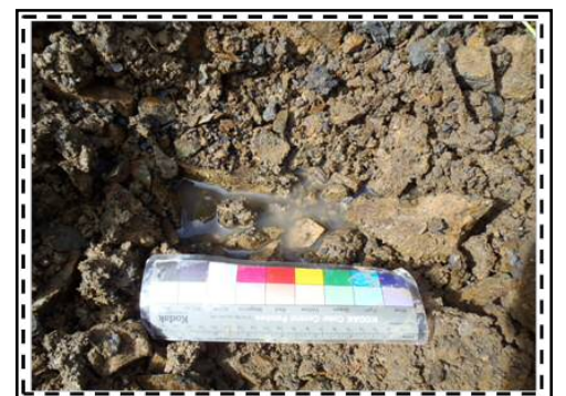
写真-3 Aのり面 地下水位
