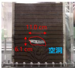
図4 空洞発生の様子 (市原砂)
