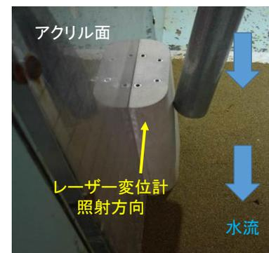
図2. 模型橋脚の設置状況
