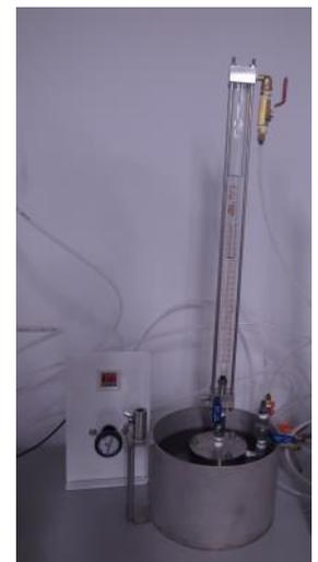
写真1 加圧式小型変水位透水試験装置
