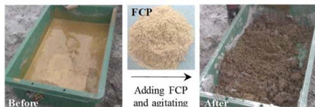
図-1 セルロース微細粉体による高含水泥土の低流動化
