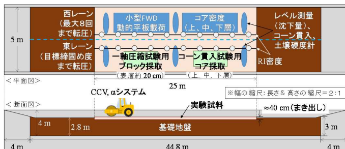
図3 締固め施工実験の概要
