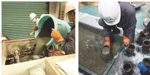
(a) 泥水の投入 (b) モールド作製
