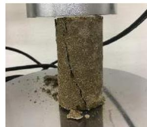
写真1 養生期間7日後の供試体Aを破壊した様子
