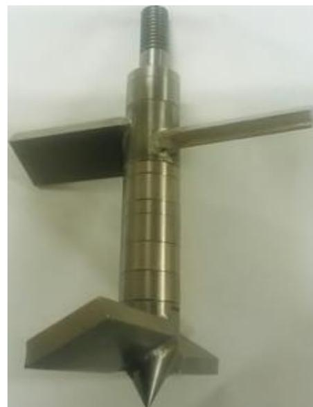
図-2 使用した攪拌翼
