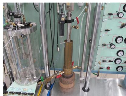
写真-1 気泡混合水の圧縮試験状況
