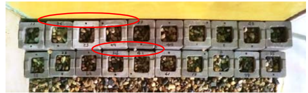
写真-1 波浪によって生じた隙間 (配置パターン 3 の例、実験後に上方から撮影)
