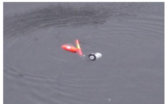
図-2 ダム貯水池の表層水を採水する様子
