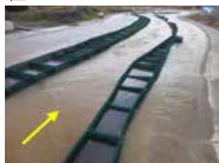
写真-2 水理実験による樹木群付近の流況
