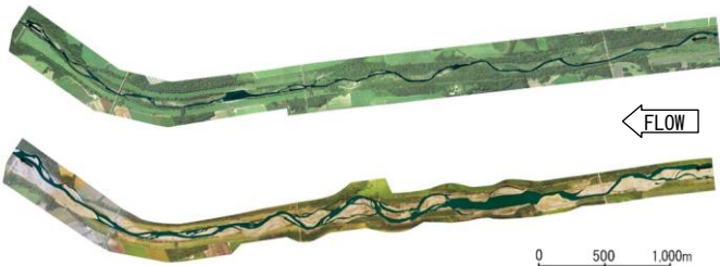
図 1 出水前後の河道の状況 (上段：出水前 H28.8.7(Google アース) , 下段：出水後 H28.9.15 ドローン撮影写真)
