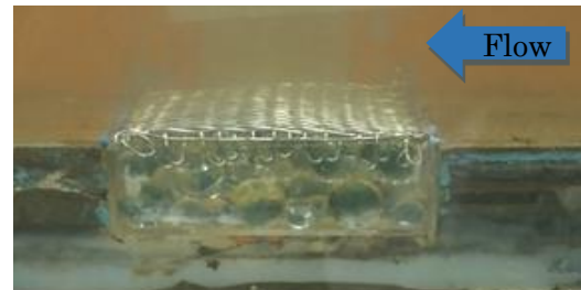
図-1 水路に設置した蛇かご模型
