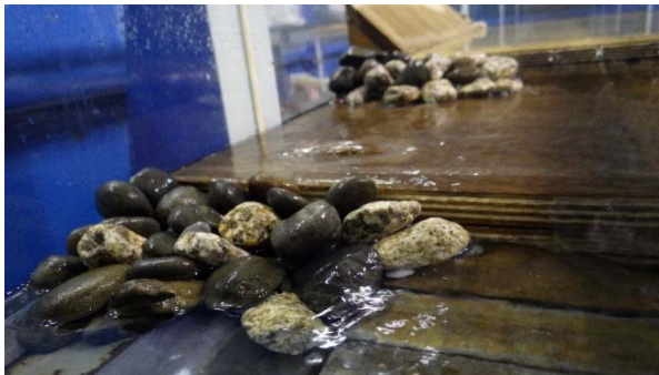
写真3 落差部に石組みした状態
