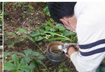
図5 リングを利用した浸透実験器具
