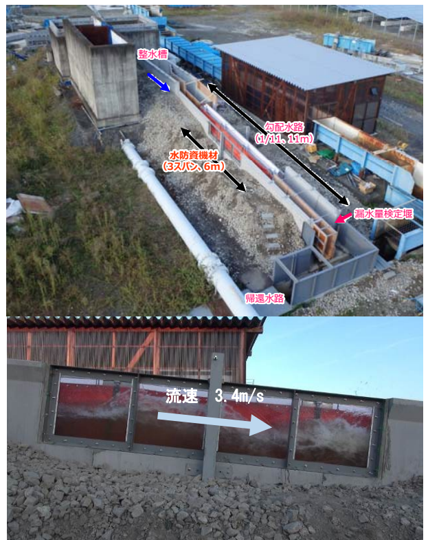
図-4 水路実験状況（流速3.4m/s）
